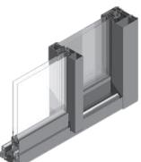
Luméal55, la baie coulissante en aluminium à ouvrant caché. Sa ligne minimalist assure un gain de **8 à 14 % de clair de vitrage** suivant son type de pose. La masse d'aluminium est réduite (-35 %) avec seulement 68 mm et 77 mm d'aluminium visible pour des performances thermiques élevées : jusqu'à **Uw = 1.2W/m².K, Sw = 0.46 et TLw = 0.65**.
