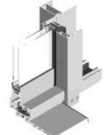
Le coulissant à galandage en aluminium permet d'exploiter au mieux les petites surfaces. Composé d'un module de 55 mm d'épaisseur **à rupture de pont thermique de 20 mm**, le galandage est robuste et discret.
