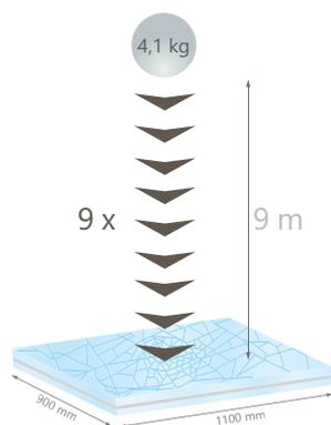
Le vitrage des panneaux verriers de la gamme LUMIERE résiste à la perforation d'une bille de 4,1 kg, lâchée 9 fois d'affilée de 9 m de haut. Pour information, la qualité au dessus de ce vitrage est le pare-balle.
